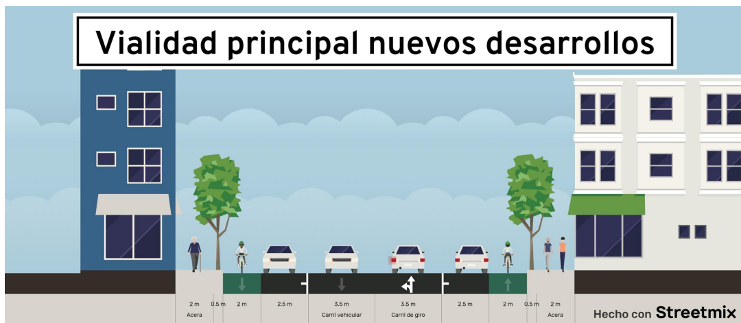
Figura 15. Imagen 1 :Sección de calle completa en tramo normal. Imagen 2:Sección de calle completa en intersección.
